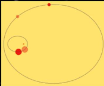
Sur la figure, on voit deux positions des deux corps décrivant des ellipses autour de leur centre de masse (le point orange).
